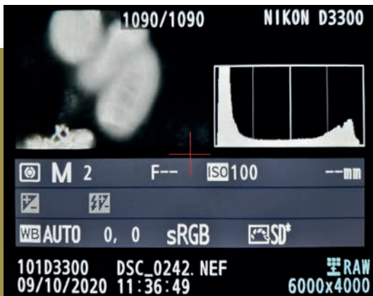
3: Lichtverteilung, die von dem im Histogramm auf dem LCD-Bildschirm dargestellten Sensor während einer fotografischen Aufnahme von Radiolarien aufgezeichnet wurde.
