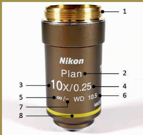
5: Allgemeine Beschreibung eines Objektivs. 1. Befestigungsgewinde; 2. Art der Korrektur optischer Abbildungsfehler (Optical Aberration Correction); 3. Vergrößerung; 4. Numerische Blende; 5. Bildabstand; 6. Arbeitsabstand; 7. Deckglasdicke; 8. Vergrößerungs-Farbcode)
